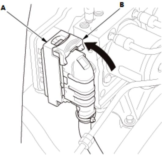
2. 对齐 VSA 调制器-控制器单元插接器 (A) 的连接表面。
