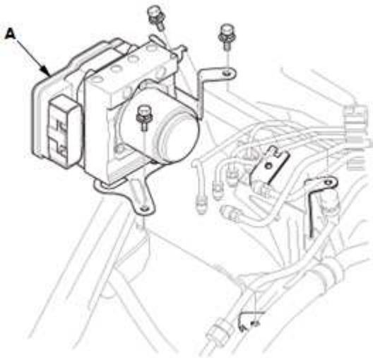
2. VSA 调节器-控制单元托架 - 拆卸
