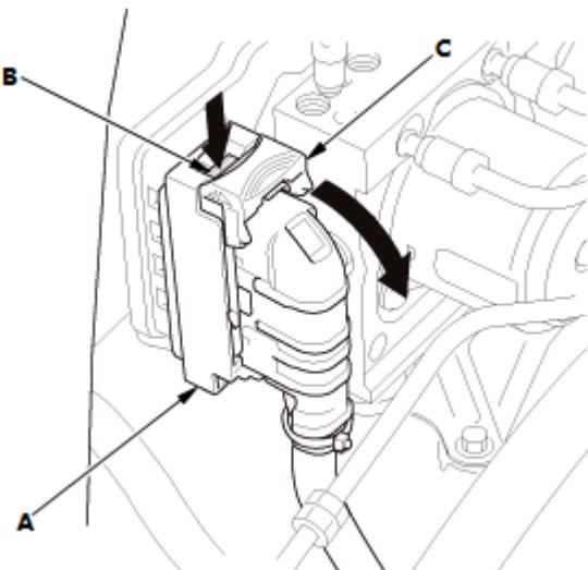
5. 拆下带托架的 VSA 调制器-控制器单元 (A)。
